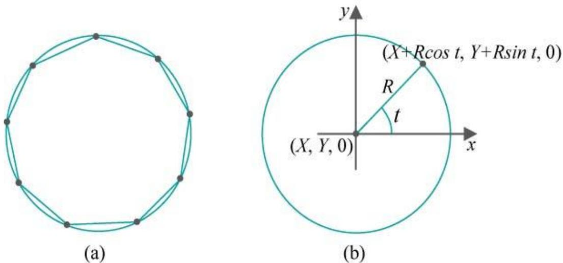
Suponha que existe uma função que imprime um ponto na tela dadas suas coordenadas  $(x, y, z)$ , como vc implementaria o círculo a partir da sua equação paramétrica  $x = X + R \cos t$ ,  $y = Y + R \sin t$ ,  $z = 0$ ,  $0 \leq t \leq 2\pi$  Onde  $(X, Y, 0)$  é o centro e  $R$  é o raio do círculo.
