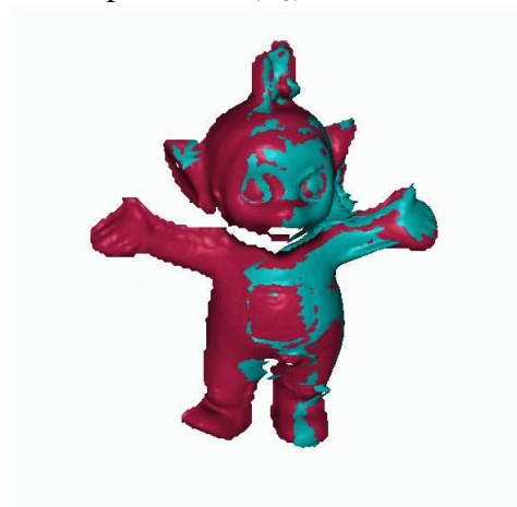
(e) Registro após refinamento de T_0 (ICP - 7 iterações)
