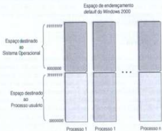
Figura 10.4 – Layout do espaço de endereçamento virtual do Windows 2000
