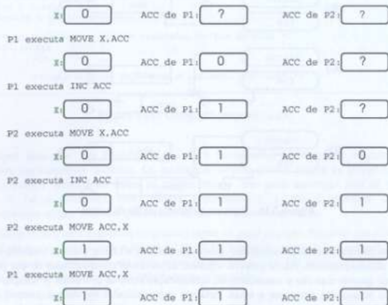
Figura 3.17 - Problema de seção crítica envolvendo uma única variável.
