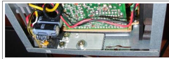
Figura 3.29: Placa fonte - Regulador monolítico instalado.
