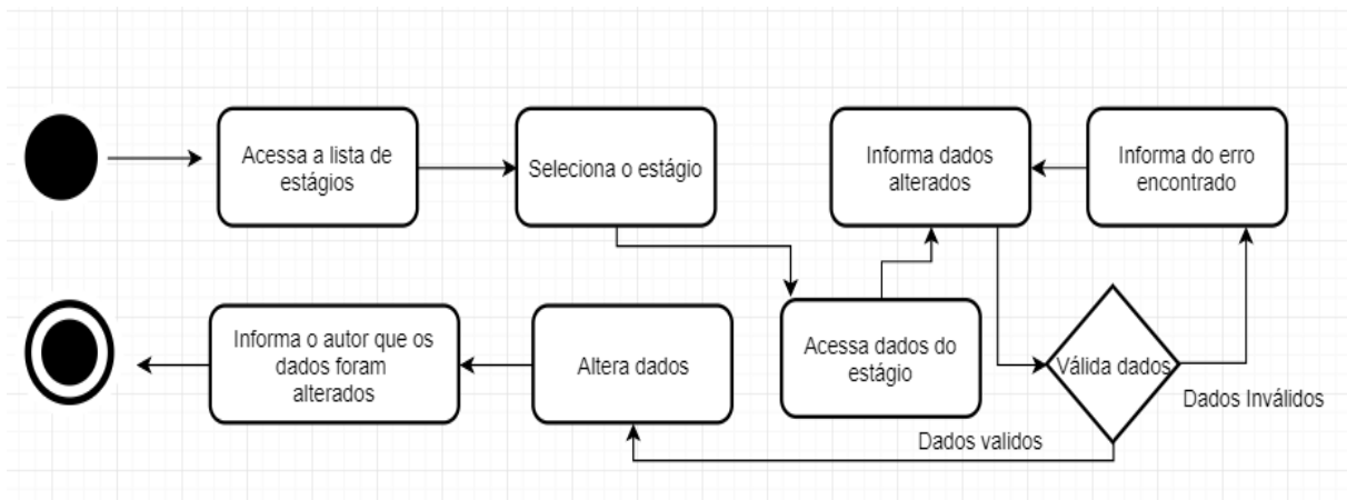
Figura 25: diagrama de atividades alteração dos dados do estágio.
