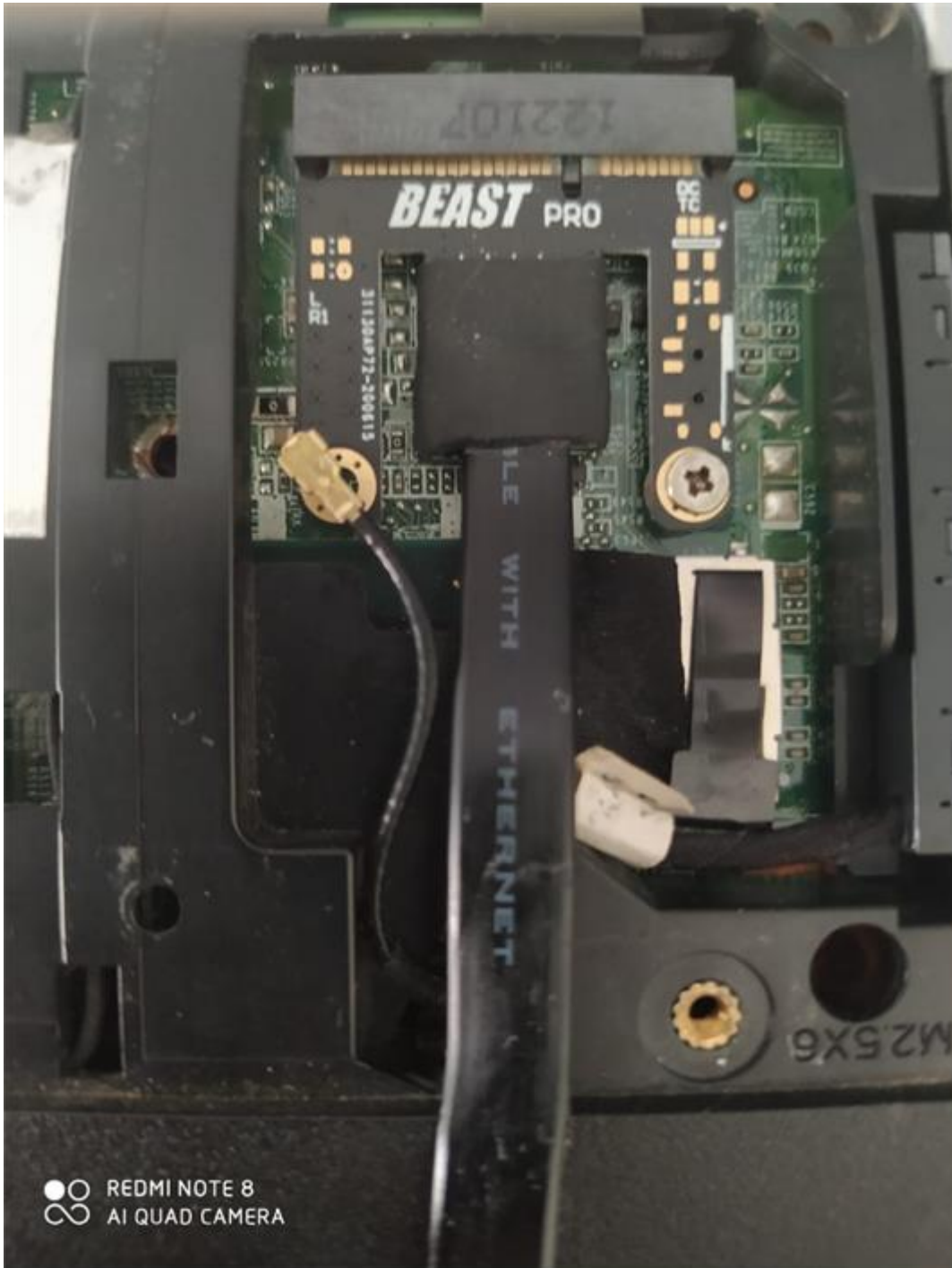
Figura 2. Conexão do adaptador no barramento mini PCI-E.
