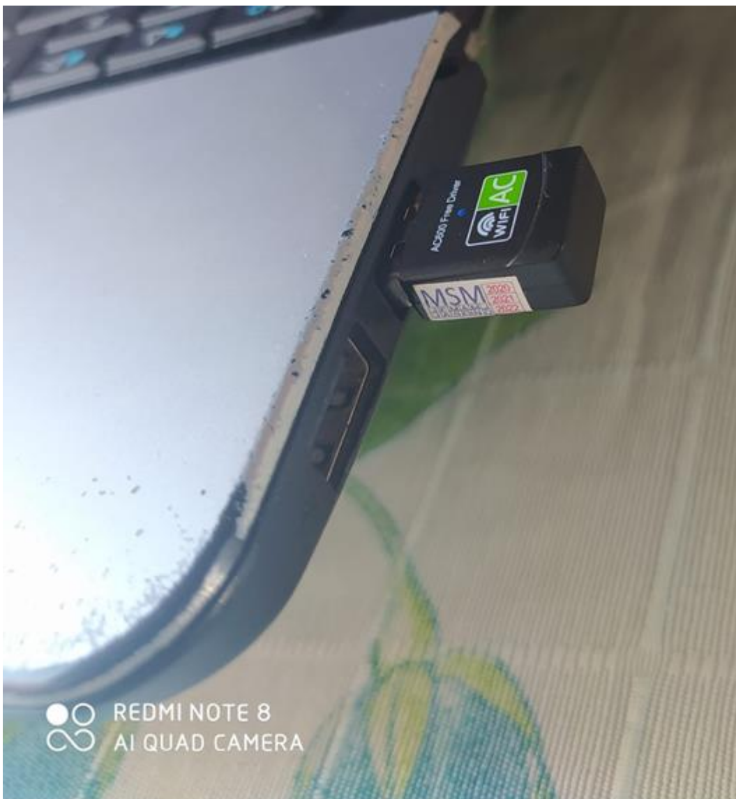
Figura 5. Conexão do Adaptador Wireless USB Dual Band, fabricante Realtek, ao notebook.
