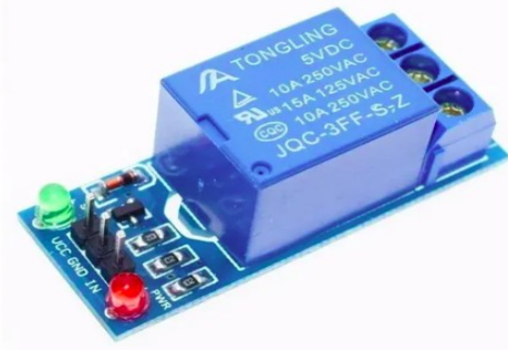
Figura 5: Módulo Relé - 1 Canal 5v/10a
