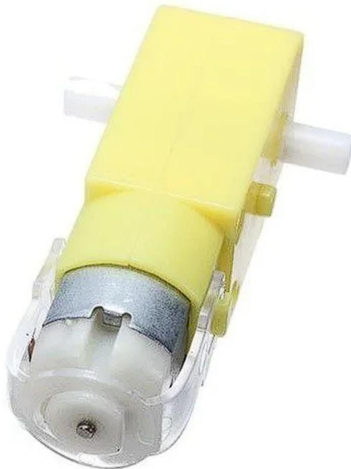
A caixa de redução acoplada a este motor tem a função transformar a alta quantidade de rotações em força de torque, ou seja, apesar de perdemos velocidade conseguimos ganhar mais força e conseqüentemente suportar mais peso.
