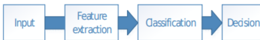
Figura 2.5: Arquitetura genérica de um sistema de reconhecimento biométrico. Fonte: (Lopes et al., 2014)
