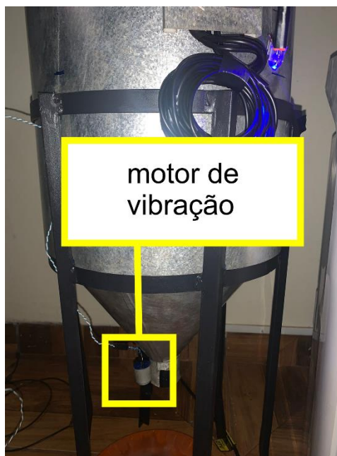
• Figura 9. Posição do motor de vibração no silo modelo – FONTE: Fonte própria.
