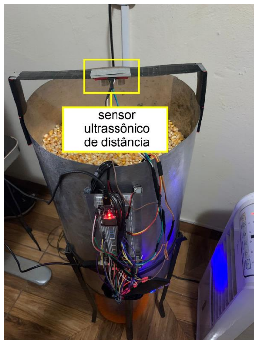
Figura 8. Posição do sensor HC-SR04 no silo modelo – FONTE: Fonte própria.
