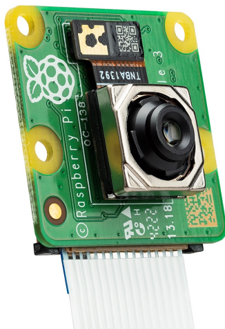
Figura 2.4: Módulo de câmera oficial Raspberry Pi
